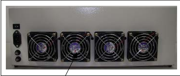
内部冷却用 FAN 4 個 ( 80x80 Longlife FAN
