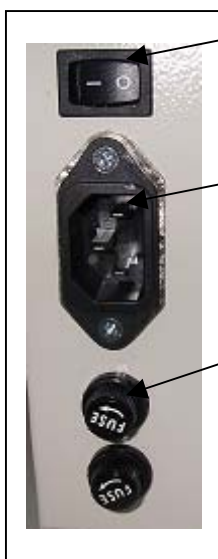
電源スイッチ “1”で電源 ON、“0”で電源 OFF
